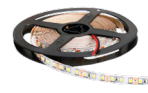
M-E.2835.120.12.20.NW.02 лента светодиодная SMD2835, 120 LED/м, 12Вт/м, 12В, 960-1080Лм/м 5000x8 мм, IP 20, 4200K (нейтральный белый)
