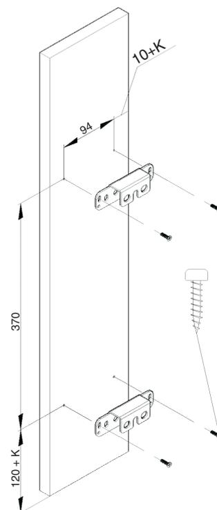
К – размер наложения фасада на панели каркаса
