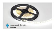
**M-E.2835.120.12.20.CW.03** Лента светодиодная SMD2835, 120 LED/м, 12Bт/м, 12B, 960-1080Лм./м 5000х8 мм, IP 20, 6000K
