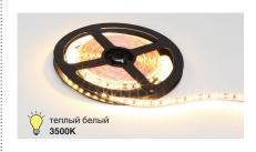
**M-E.2835.120.12.20.WW.01** лента светодиодная SMD2835, 120 LED/м, 12Bт/м, 12B, 960-1080Лм./м 5000х8 мм, IP 20, 3500K
