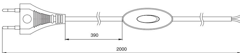
провод сетевой 2000 мм с вилкой Europlug и проходным выключателем
