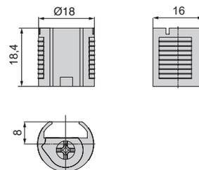
полкодержатель врезной d.18 мм с фиксацией, для ДСП 26мм
