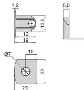
упор для полкодержателя SO013, под саморез или евровинт\*
