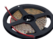
M-E.2835.120.9.6.20.CW.33 лента светодиодная SMD2835, 120 LED/м, 9,6Вт/м, 12В, 900Лм./м 5000х5 мм, IP 20, 6000K (холодный белый)
