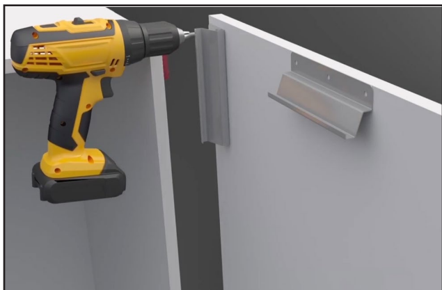
11. Установка боковой стенки на каркас колонны.
