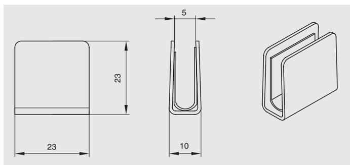
накладки для стекла 5мм, для защелки Push-Latch M
