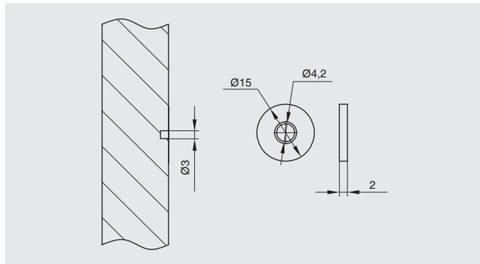
ответная часть d.15мм под шуруп
