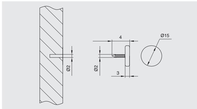
ответная часть d.15мм на гвоздике
