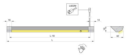
**Важно:** Для подключения светильника к сети Вам потребуется комплект источника питания 12В, мощность которого соответствует суммарной мощности подключаемых светильников с запасом минимум 10%.
