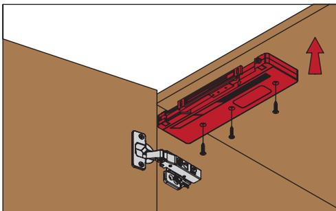
3. отрегулируйте работу механизма и зазор между фасадом и каркасом с помощью винта
