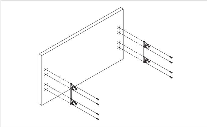
**ШАГ 3. Монтаж креплений фасада.** Нужно использовать шурупы, которые идут в комплекте с креплениями. (Шурупы и крепления упакованы вместе и запаяны в отдельный пакет).
