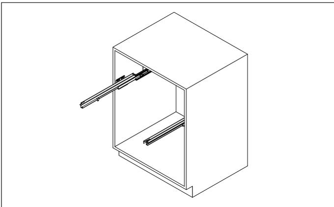
**ШАГ 5. Установка направляющих на каркас ящика.** Для фиксации направляющих на боковые стенки ящика мы рекомендуем использовать евроинты 6,3x13, также допустимо использование шурупов 4 x16 с головкой потай.
