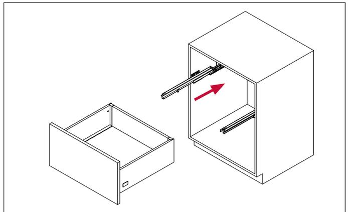
**ШАГ 6. Монтаж ящика на направляющие.** Ящик устанавливаем на полностью выдвинутые направляющие или на полностью задвинутые. Важно избегать ситуации с неравномерным выдвиганием направляющих.
