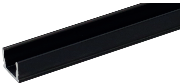
Профиль 1007 для LED подсветки накладной, L=3000 мм, алюминий анодированный черный
