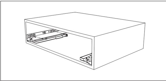
**Шаг 3.** Установка синхронизатора.
