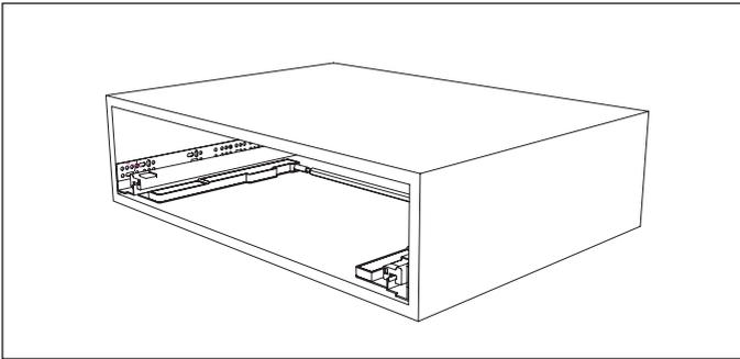
**Шаг 5.** Установка ящика в корпус.
