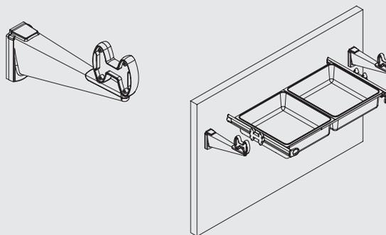
Возможна установка на полку с помощью опоры для крепления выдвигаемых элементов к полкам арт. **SSNBP163x**
