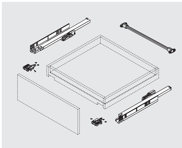
комплект для синхронизации направляющих серии INN.FPL6, L=1100мм
