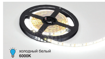
M-E.2835.120.12.20.CW.03 Лента светодиодная SMD2835, 120 LED/м, 12Вт/м, 12В, 960-1080Лм./м 5000x8 мм, IP 20, 6000K
