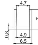
**профиль торцевой для стеновых панелей**
