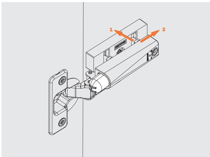
5 – отрегулируйте усилие SMOVEHOLDER регулировочным винтом
