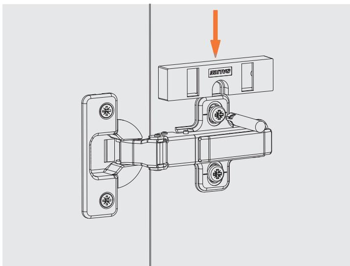
3 – зафиксируйте адаптер крепежным винтом ответной планки
