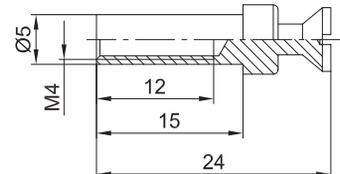
**шток двусторонний (мама) для стяжки эксцентриковой V20 и VG20**
