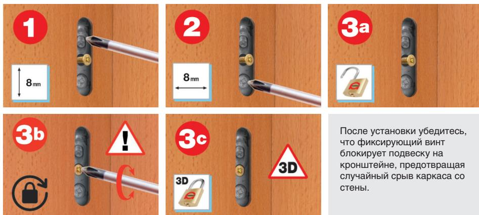
После установки убедитесь, что фиксирующий винт блокирует подвеску на кронштейне, предотвращая случайный срыв каркаса со стены.
