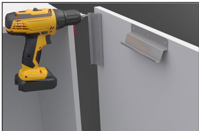
11. Установка боковой стенки на каркас колонны.
