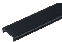
HW.012.1718.3000.FR.Black профиль-рассеиватель 1718 для LED подсветки, L=3000мм, отделка черный матовый, тип "clip"
