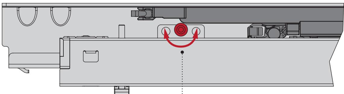
Вращая гайку у основания "пина" получаем регулировку по высоте 0 – 3 мм.
