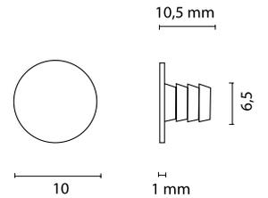
**Push-Latch Ответная часть d=10мм на бобышке 6.5мм, никель**
