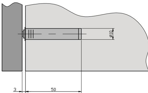
Схема установки PUSH-LATCH 40 защелки врезной
