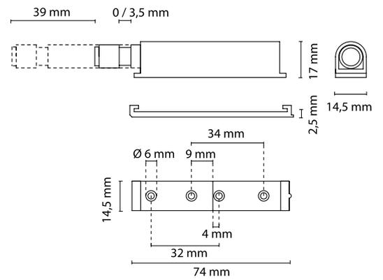
**Push-Latch 40 Защелка накладная с амортизатором**
