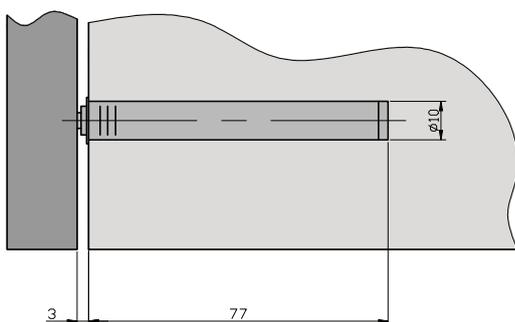
Схема установки PUSH-LATCH 40 защелки накладной
