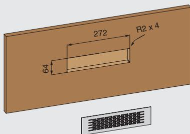
\* площадь сечения вентиляционных отверстий
