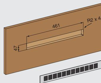
\* площадь сечения вентиляционных отверстий
