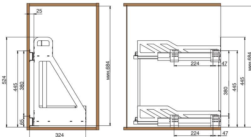
**ШАГ 1.** При помощи 8-ми винтов и 8-ми гаек идущих в комплекте, устанавливаем проставки на направляющие.
