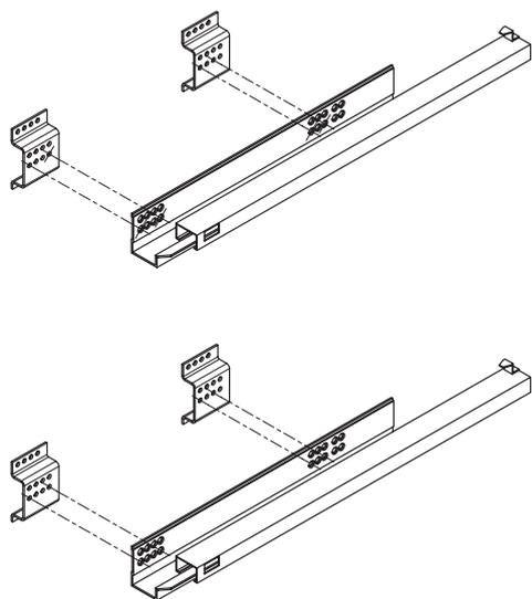
**ШАГ 2.** Присаживаем направляющие на боковые стенки каркаса.
