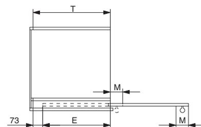
**Формула вычисления полезной глубины каркаса шкафа**
