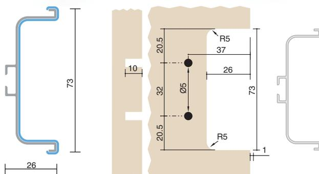
профиль горизонтальный с двумя закруглениями
