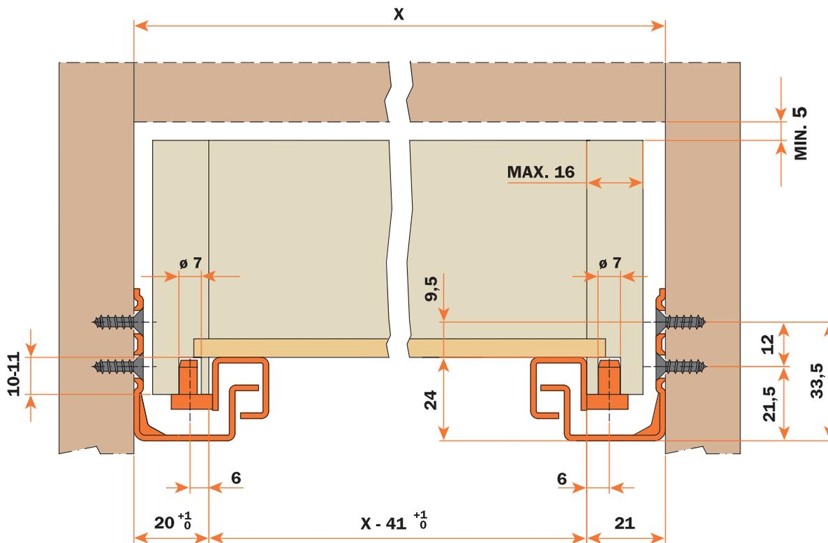
Схема присадки направляющих к боковине каркаса
