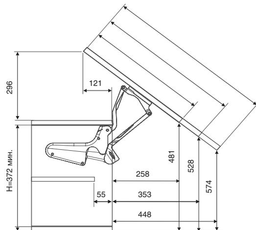
SPIN - 4 44-72 подъемник наклонного подъема
