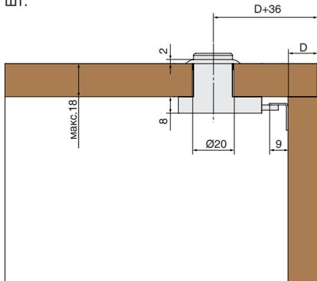
D - размер наложения фасада на боковую панель каркаса
