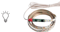
KIT.2835.NW.AD003.3000.19 комплект SMD2835, 4200K, 3000x8 мм с сенс. выкл., каб. питания 2м, 120 LED/м, 12Вт/м, 12В, 1080Лм.
