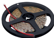
M-E.2835.120.9,6.20.NW.32 лента SMD2835, 120 LED/м, 9,6Вт/м, 12В, 900Лм./м 5000х5 мм, IP 20, 4200K (нейтральный белый)
