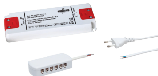
KIT.SNP50-12.16.1.0 комплект источника питания 50Вт, 200-240В/12В с блоком распредел. парал. подключ. для кон-ра L822 и проводом сетевым
