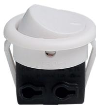
**выключатель круглый D23мм, перекидной врезной меб., 250В, 6А, с пружинными терминалами для пров. 0,5-1,0мм<sup>2</sup>, белый**
