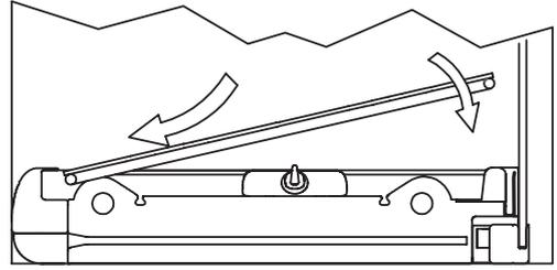
Поверните защитный предохранитель для фиксации решетки
