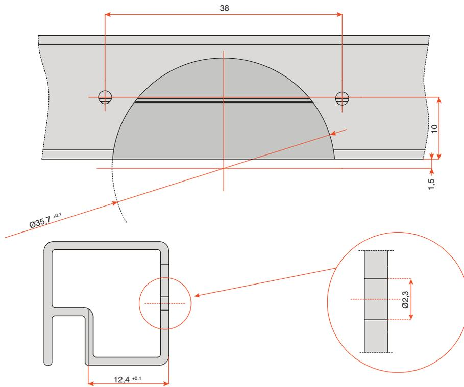
Схема установки петли с доводчиком для узкого алюминиевого профиля шириной 20 мм
