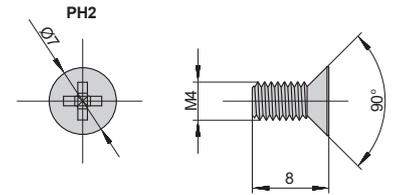
**винт M4x8 для сборочных уголков, головка потай, шлиц PH2**
