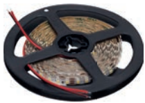
M-E.2835.120.12.20.NW.02 лента светодиодная SMD2835, 120 LED/м, 12Вт/м, 12В, 960-1080Лм./м 5000х8 мм, IP 20, 4200K (нейтральный белый)
