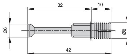
шток быстрого монтажа 8x10/34мм для стяжки эксцентриковой
