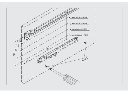
Схема присадки и установки активатора
