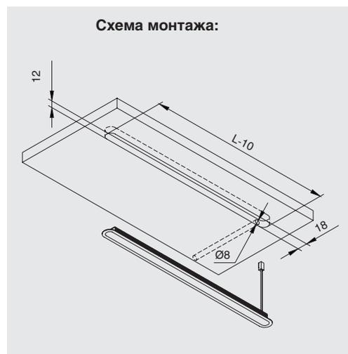
**Важно:** Для подключения светильника к сети Вам потребуется комплект источника питания 12В, мощность которого соответствует суммарной мощности подключаемых светильников с запасом минимум 10%.
