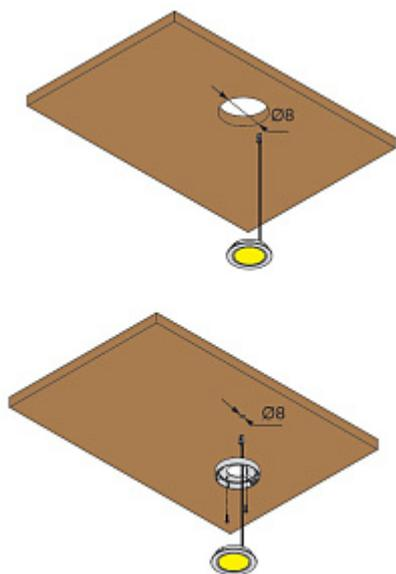
СХЕМА ПОДКЛЮЧЕНИЯ СВЕТИЛЬНИКОВ
