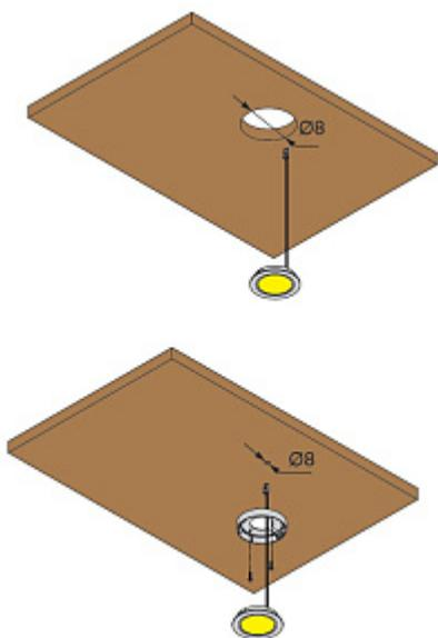
СХЕМА ПОДКЛЮЧЕНИЯ СВЕТИЛЬНИКОВ
