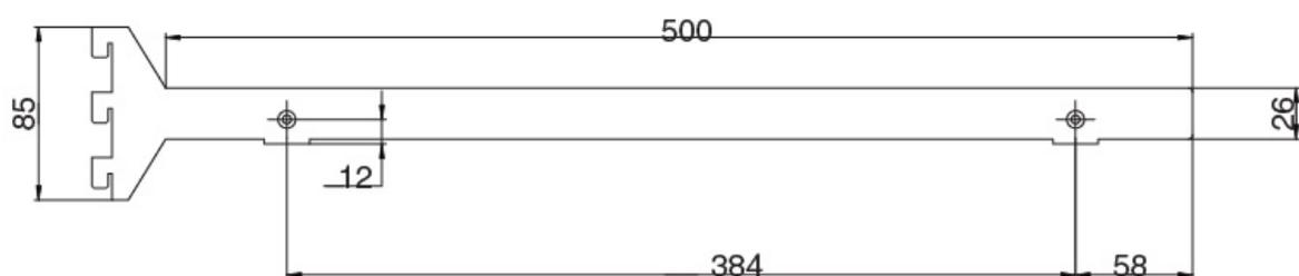
Если толщина задних вертикальных панелей 18 мм, то глубина полки составляет 500 мм, как указано на схеме выше. Если панели 16 мм., то глубина полки – 502 мм.
