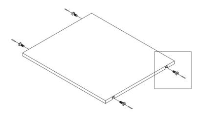
Металический штифт забивается в отверстие расположенное на ножке полкодержателя. Данная операция производится для надежной фиксации полкодержателя в корпусе полки.
