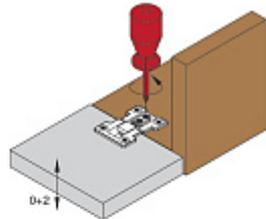
После проведения регулировок зафиксируйте винт и установите отгибную
