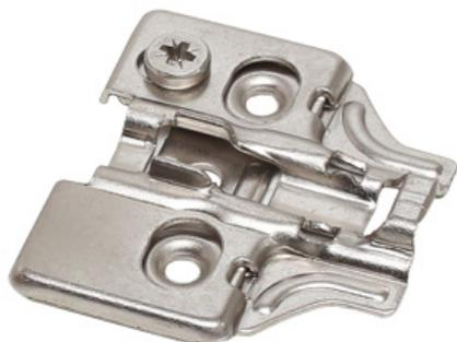
Ответные планки оснащены встроенным эксцентриком, который позволяет производить регулировку по высоте  $\pm 2$ мм. Данные ответные планки совместимы с петлями серий МН.414 и МН.304.51.
