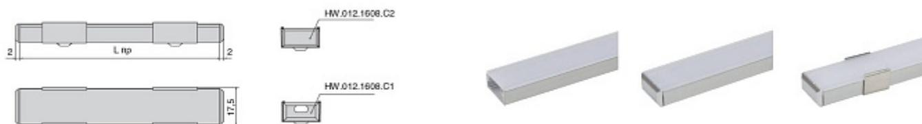
Важно: при монтаже ставить 1 клипсу на каждые 400 мм профиля
