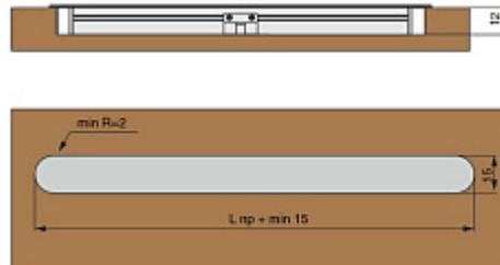
Важно! при монтаже через клепсу, нужно ставить 1 клепсу на каждые 400 мм профиля
