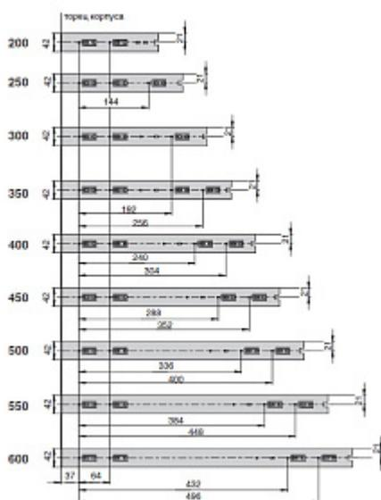
Схема крепления направляющих к каркасу ящика
